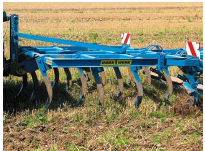
Abb. 4: Traditionelle Doppelherzschargrubber eignen sich hervorragend zum Einmischen von Stroh bei Arbeitstiefen von zirka 15 cm. Für flaches Arbeiten ist eine Umrüstung auf Gänsefusschare notwendig.
