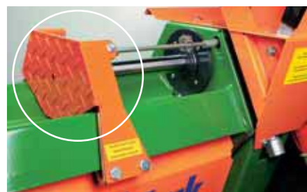
Glissière avec plaques de pression, en laiton pour une plus grande longévité
