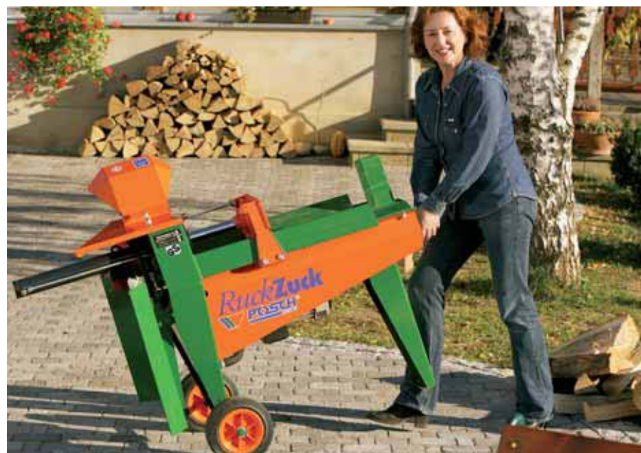
Facilité de transport grâce aux grandes roues à bandage en caoutchouc plein de 300 mm de diamètre.
