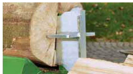
coin étoile 4 tranchants retournable F0001893 enfichable, pour quatre bûches en une opération – comme équipement spécial.
