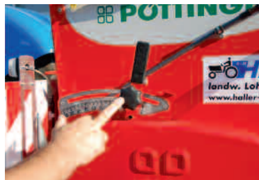
Nach der Abdrehprobe kann die Dosierung angepasst werden.
